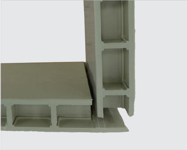
Kreuzverrippte Platten sind vor dem Extrusionsschweißen ähnlich wie längsverrippte Platten vorzubereiten.
