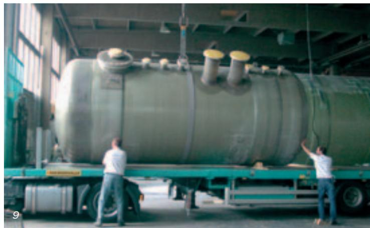
9 Cuve en composite renforcé fibres de verre prête pour le transport
