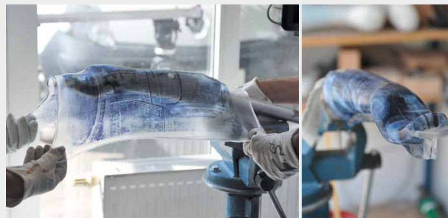
Termoformowanie płyty SIMONA® SIMOLIFE PE-HWV zabarwionej papierem termicznym do kształtu gipsowego modelu przedramienia.
