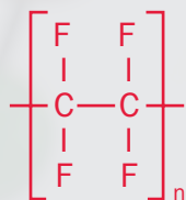
rys. 3: w pełni fluorowane tworzywo sztuczne, np. PTFE (politetrafluoroetylen)
