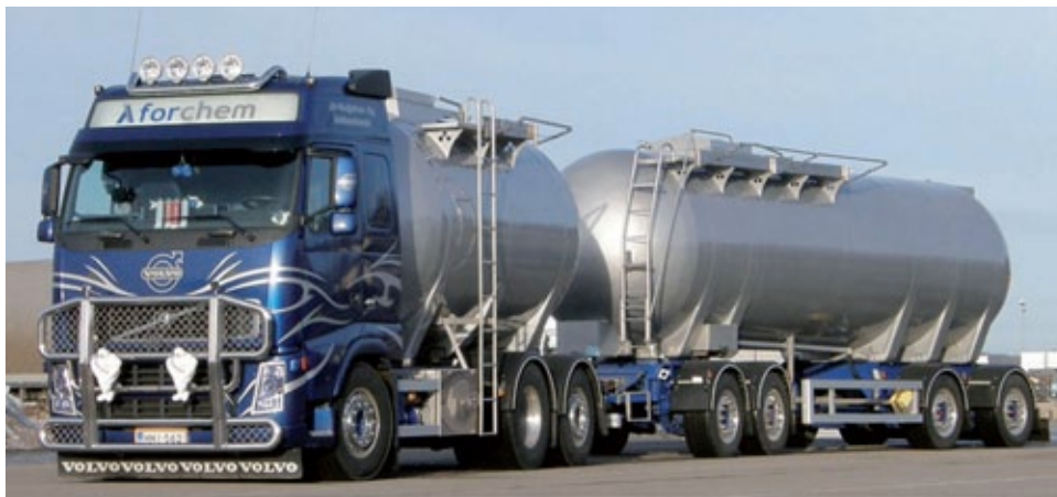
Cysterny transportowe o pojemności 18 lub 31 m 3 z podwójną wykładziną SIMONA® E-CTFE-AK o grubości 2,3 mm
