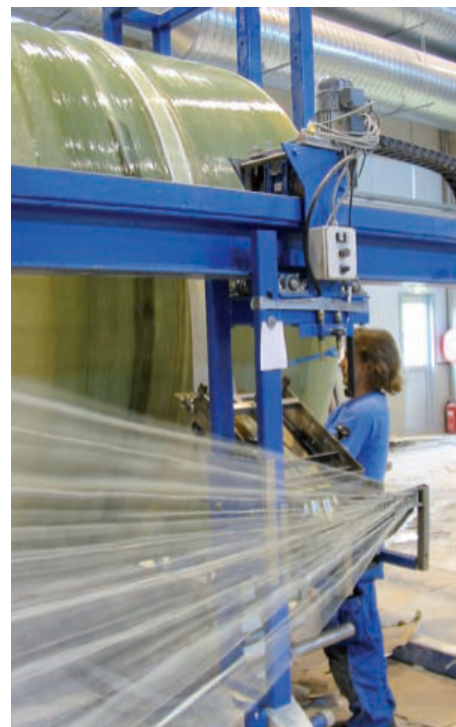
Nakładanie struktury GFK poprzez nawinięcie filamentu na leżące pod spodem tworzywo wykładziny SIMONA® E-CTFE-AK
