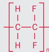
rys. 2: częściowo fluorowane tworzywo sztuczne, np. PVDF (polifluorek winylidenu)
